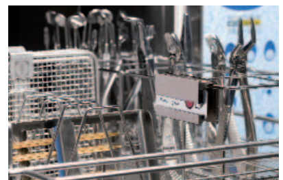
Abb. 1: Die Wash-Checks – ein Testsystem zur chargenbezogenen Bewertung der Reinigungsleistung sowie zur Validierung des Reinigungsprozesses.
